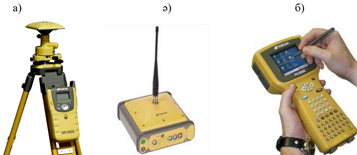
2.13 - сурет– а) штативке орнатылған Торсон GB - 1000 қабылдағышы ; ә) Торсон HiPer қабылдағышы; б) FC-2000 контроллері
