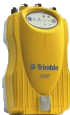
2.12 - сурет – Trimble TS 5700 GPS қабылдағышы
