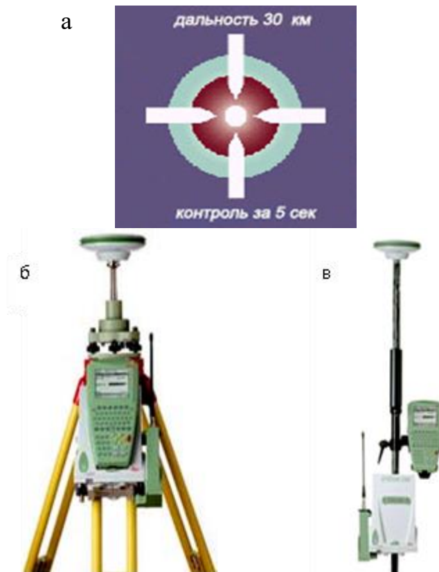
2.6-сурет – SmartTrack– технологиялық антенна а) SmartTrack – технологиялық кіші антенна; б) штативке орнатылған GPS1200 сериялы қабылдағыш; в) вешка орналасқан антенна, далалық ровер және модем.
